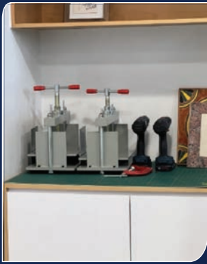
جهاز يستخدم كبس الورق لمدة يومين ليتماسك الكتاب
